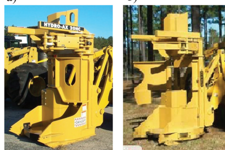
Rys. 4. Głowice ścinkowe: a) 206, b) 227 [2]
