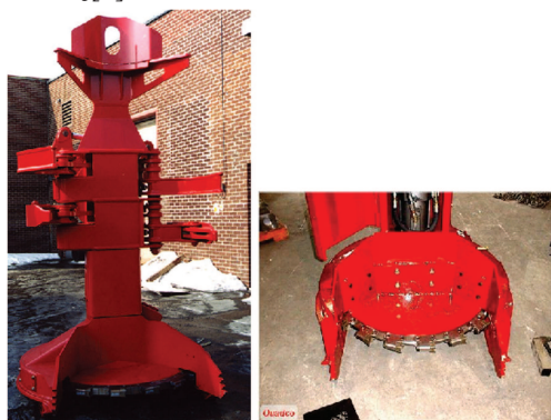
Rys. 2. Głowica ścinkowa z serii C i jej mechanizm tnący [2]
