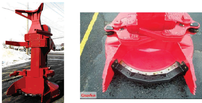
Rys. 1. Głowica ścinkowa Quadco serii B i jej mechanizm tnący wraz z osłoną [2]
