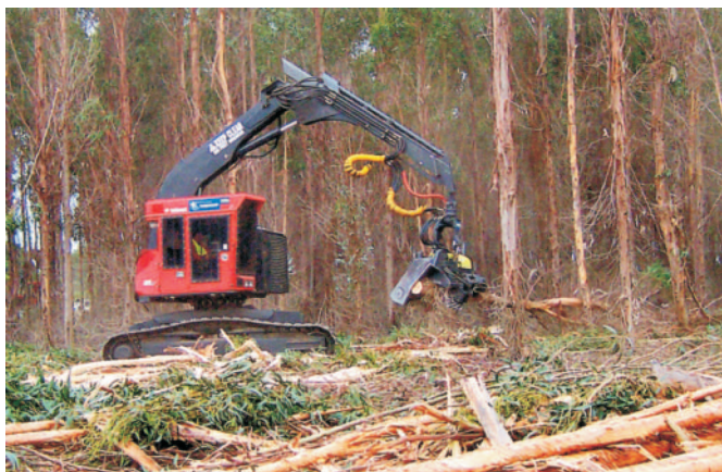
Rys. 5. Harwester wysięgnikowy na nośniku gąsienicowym Fig. 5. Boom harvester on caterpillar carrier
