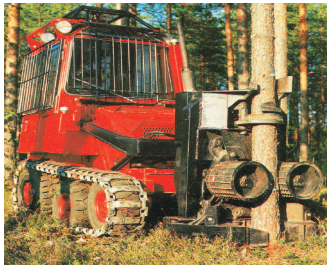
Rys. 2. Harwester czołowy Makeri na nośniku kołowym z założonymi półgąsienicami
