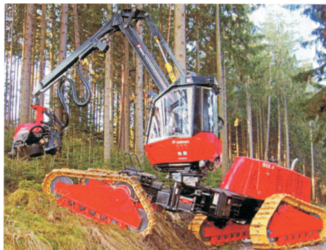
Rys. 4. Harwester wysięgnikowy wsparty na czterech gąsienicach
