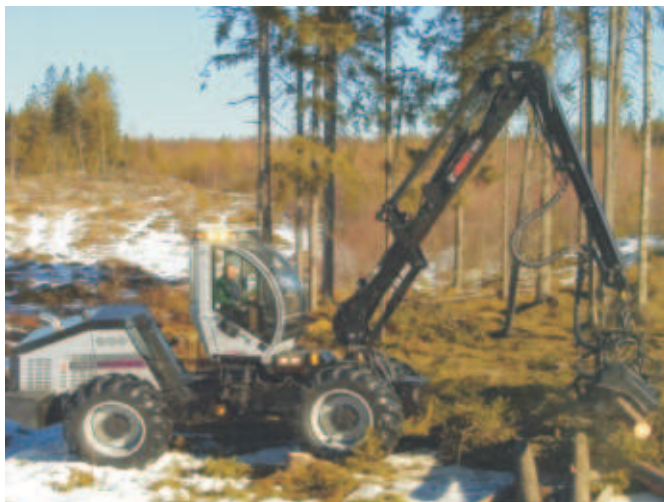
Fys. 3. Mały harwester wysięgnikowy na nośniku kołowym Fig. 3. Small boom harvester on wheel carrier
