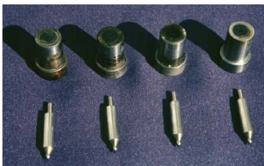
Fot. 3. Stan rozpylaczy po 155 000 km.
