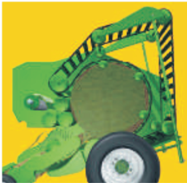
Rys. 1. Zwijanie materiału za pomocą pasa listwowego Fig. 1. Material scrolling by the slat belt
