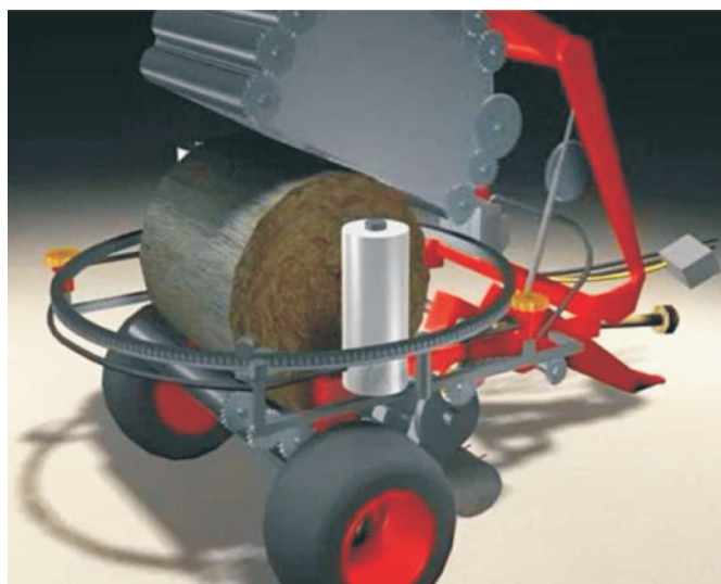
Rys. 3. Owijanie beli za pomocą dwóch aparatów z rolkami poruszającymi się po pierścieniu okrążającym belę
