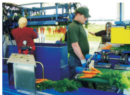
b) wyrwana z nacią marchew trafia do myjki a następnie do zespołu wiążącego b) plucked, topped carrots are transferred to the washing unit and then to the bunching unit
