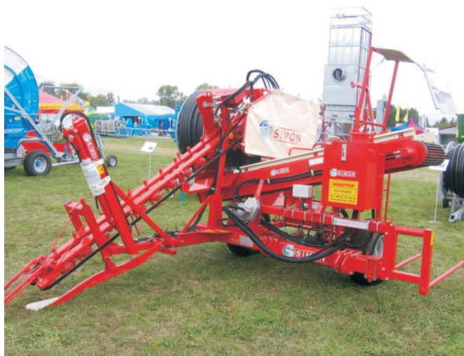
Rys. 2. Jednorzędowy kombajn wrywający firmy Simon z przenośnikiem sortującym i ładującym zebrany plon do skrzynio-palety
