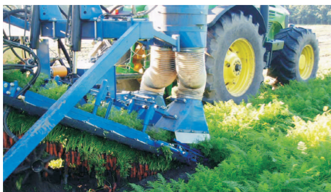
Rys. 3. W kombajnie T-200 BU do czyszczenia naci zastosowano zespół pneumatyczny, a do korzeni marchwi otrząsacze palcowe
