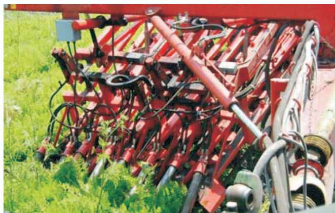
Rys. 1. Zespół wrywający z napędzanymi hydraulicznie podnośnikami naci przyczepianego kombajnu firmy Dewulf do zbioru marchwi z zagonów
