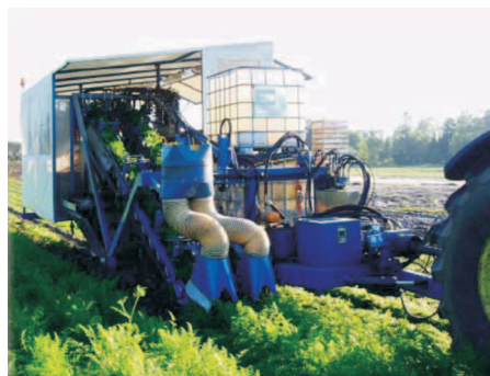
a) widok na zespół wyrywający, zadaszanie i zbiorniki na wodę a) uprooting unit, roof and water containers
