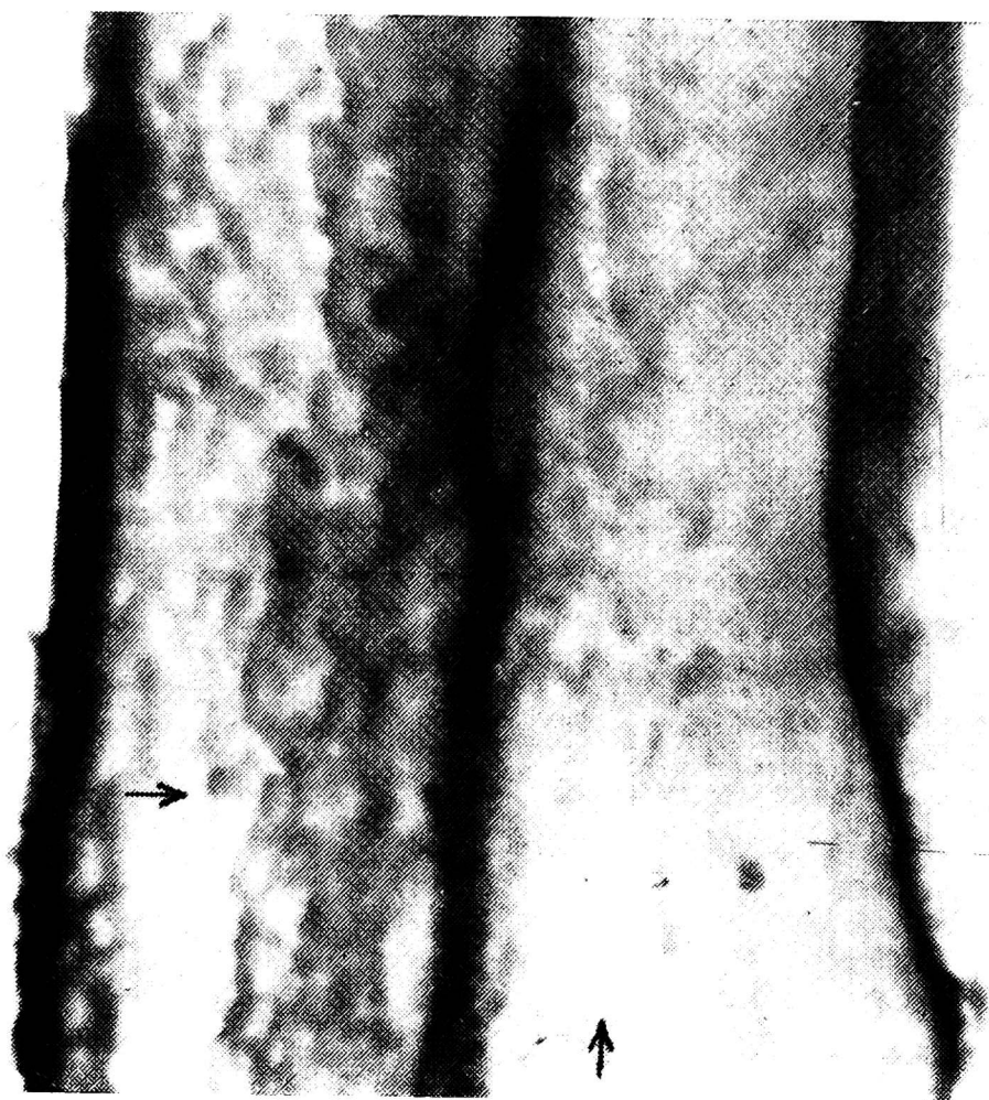
Rys. 2. Ścianki komórkowe cewek drewna świerkowego po impregnacji (1% \text{Na}_2\text{O} , 5% \text{SO}_2 og., 120 min, temp. 110^\circ\text{C} ), (pow. 5000\times )
