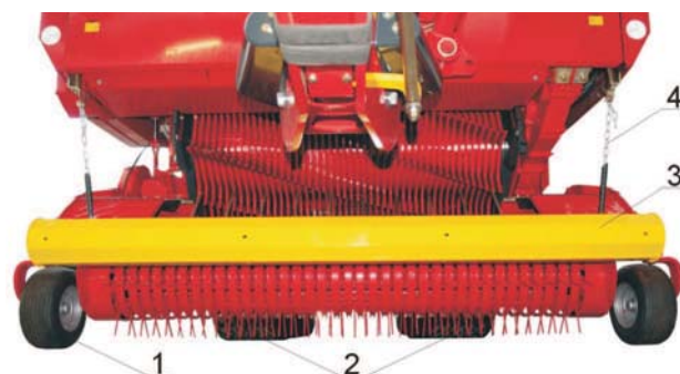
Rys. 6. Usytuowanie kół podporowych podbieracza w przyczepie Jumbo Combiline firmy Pöttinger [10]: 1 - koła podporowa, 2 - bliźniacze koła kopiujące, 3 - dociskacz rolkowy, 4 - ramiona nośne
