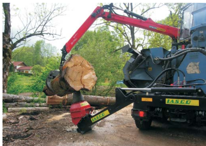
Rys. 6. Głowice stożkowe firmy Lasco podczas łupania drewna od góry i od dołu [7] Fig. 6. Conical heads of Lasco while splitting wood at the top and bottom [7]
