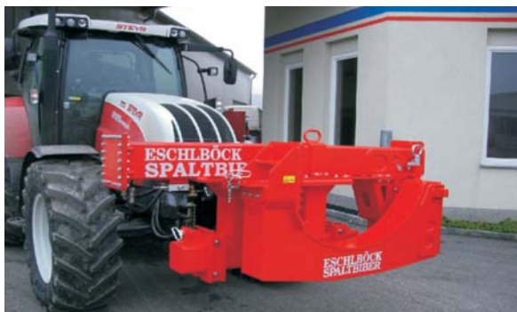
Rys. 5. Głowica z klinem łupiącym Spaltbiber 80 firmy Eschlböck w położeniu roboczym i transportowym [6] Fig. 5. Spaltbiber 80 splitting head of Eschlböck in the working position and transport [6]
