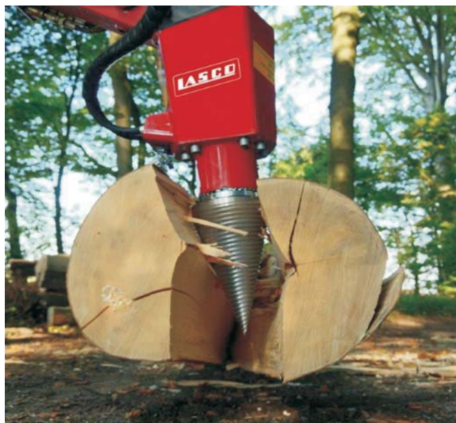
Rys. 4. Głowica z klinem łupiącym SPZ 110 firmy Auer pracująca na żurawiu nośnika [5] Fig. 4. SPZ 110 splitting head of Auer while working on the boom [5]
