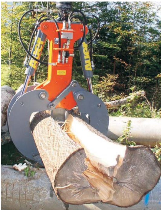
Rys. 4. Głowica z klinem łupiącym SPZ 110 firmy Auer pracująca na żurawiu nośnika [5] Fig. 4. SPZ 110 splitting head of Auer while working on the boom [5]
