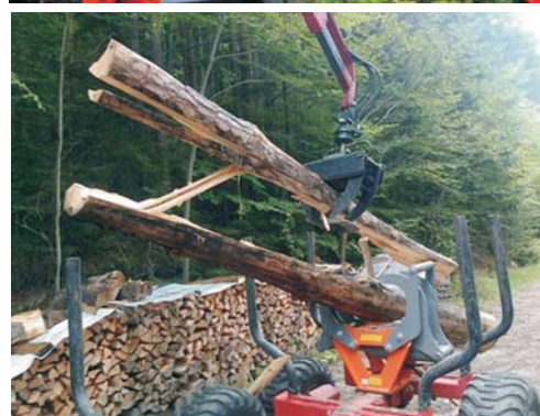
Rys. 1. Głowica łupiąca SPZ125 firmy Auer w czasie pracy na wysięgniku i na ramie przyczepy zrywkowej [5] Fig. 1. SPZ125 splitting head of Auer while working on the boom and the frame logging trailers [5]
