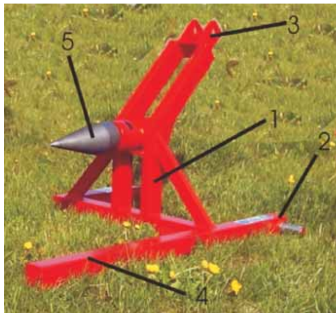
Rys. 3. Łuparka stożkowa: 1 - rama, 2 - sworznie do mocowania cięgien podnośnika, 3 - łącznik górnego podnośnika, 4 - zabezpieczenie, 5 - głowica stożkowa Fig. 3. Conical splitting machine: 1 - frame, 2 - the pins to attach lift tendons, 3 - upper connector of elevator, 4 - safeguard, 5 - conical head
