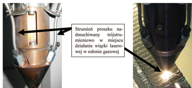
Rys. 2. Widok trójstrumieniowej głowicy napawającej
