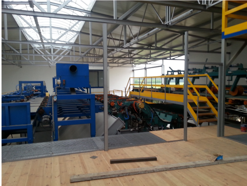
Bild 8. Automatische Besäumanlage in Sägewerk Zębowo (fot. Maleta)
