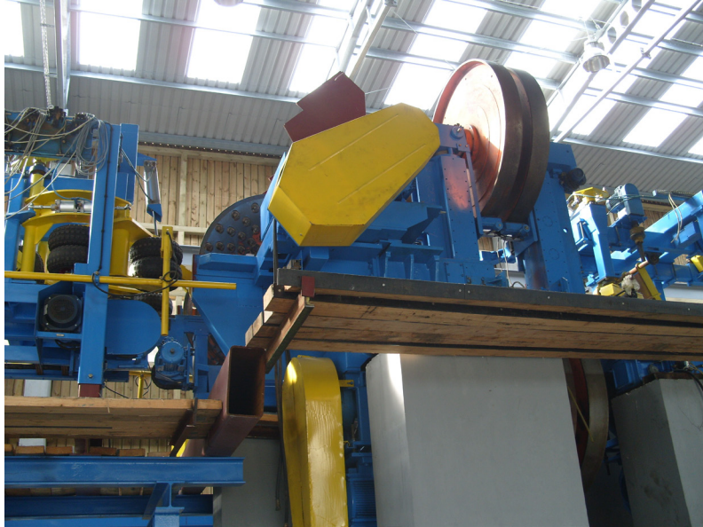
Bild 3. Spaner- und Bandsägengruppe während der Montage in Kalisz Pomorski (fot. Krzosek)
