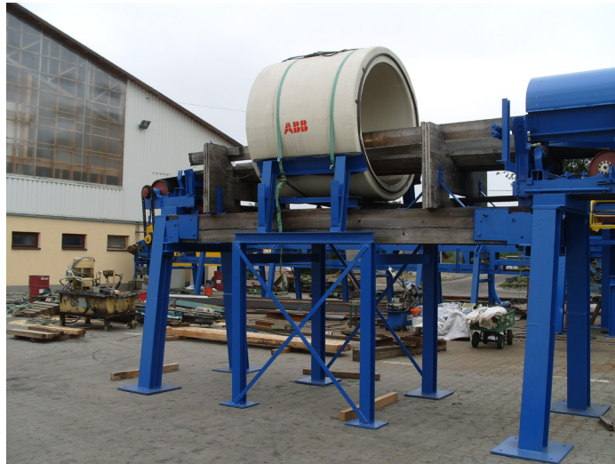
Bild 7. Metallsuchgerät vor der Sägehalle im Sägewerk Witkowsky (fot. Krzosek)
