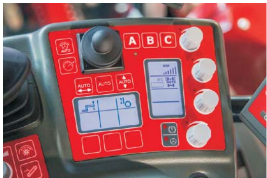
Rys. 3. Ergonomiczny i intuicyjny system obsługi ErgoDrive do samobieżnych kombajnów ziemniaczanych z możliwością indywidualnego programowania [2]
