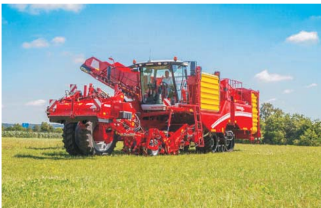
Rys. 2. Kombajn samobieżny Varitron 270 Platinum Terra Trac z gąsienicowym układem jezdym [2]
