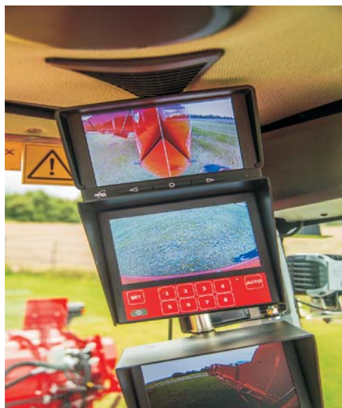
Rys. 5. System ProCam do monitoringu obszaru po bokach maszyny [2]
