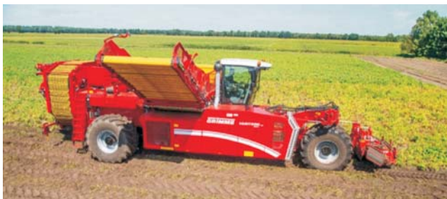
Rys. 1. Kombajn samobieżny Varitron 270 Platinum z kołowym zespołem jezdnym [2]
