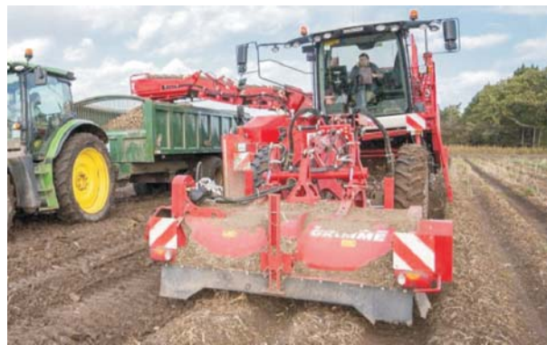
Rys. 4. Samobieżny kombajn ziemniaczany Varitron 220 Platinum Terra Trac z gąsienicowym układem jezdym [2]
