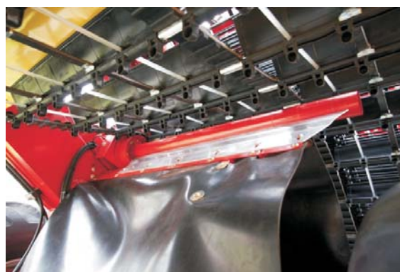
Rys. 8. Mechaniczny wałek czyszczący oś w kombajnach do zbioru ziemniaków [2] Fig. 8. The mechanical roller cleaning the axle in potato harvesters [2]
