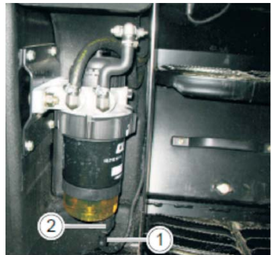
Rys. 6. Odstojnik paliwa niezapowietrzonego ciągnika John Deere 6150R (a), odstojnik paliwa w ciągniku Claas Arion (b): 1 - czujnik wody w filtrze paliwa informuje operatora o wodzie w paliwie, 2 - korek do zlewania wody z filtra Fig. 6. John Deere 6150R non-aerated fuel tank (a), fuel tank in the Claas Arion tractor (b): 1 - the water sensor in the fuel filter informs the operator of the water in the fuel, 2 - the filter plug for the water
