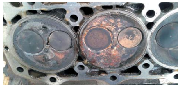
Rys. 3. Głowica pokryta produktami spalania, m.in. popioły siarczanowe, które nie ulegają wypaleniu
