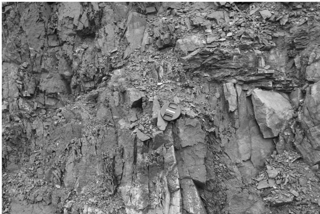
Figure 4. Porphyry cracks in Gorce I deposit (author: Ł. Zbucki) Rysunek 4. Spękania porfirów w złożu Gorce I (autor: Ł. Zbucki)
