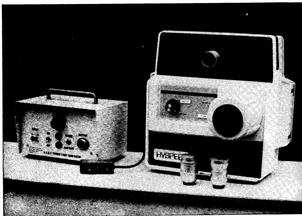
Rys. 5. Kamera filmowa do zdjęć szybkich Hyspeed z frekwencją od 10 do 6500 \text{ kl} \cdot \text{s}^{-1} (fot. W. W. Woźniak)
