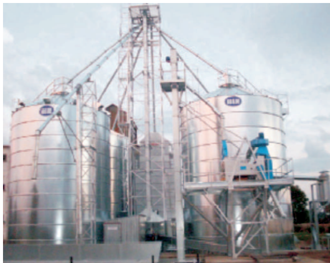
Rys. 1. Zestaw urządzeń do przechowywania i transportu zbóż z możliwością kontroli jakości w czasie magazynowania produkowany przez BIN Sp. z o.o. w Aleksandrowie Kujawskim Fig. 1. Set of devices for storing and transport of cereal crops with the possibility of the quality check during storing manufactured by BIN Sp. z o.o., Aleksandrów Kujawski (Poland)
