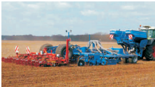
Rys. 2. Wieloczynnościowy agregat uprawowo-siewny „Master” w technologii Strip Till produkowany przez Köckerling GmbH & CO.KG (Niemcy)
