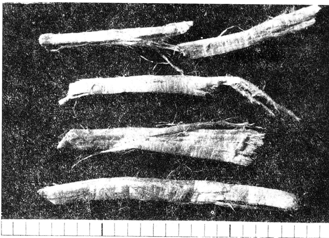
Rys. 1. Pęczki włókien i włókna sosnowej masy defibratorowej (mikroskop stereoskopowy), 1 podziałka na rysunku odpowiada 1 mm
