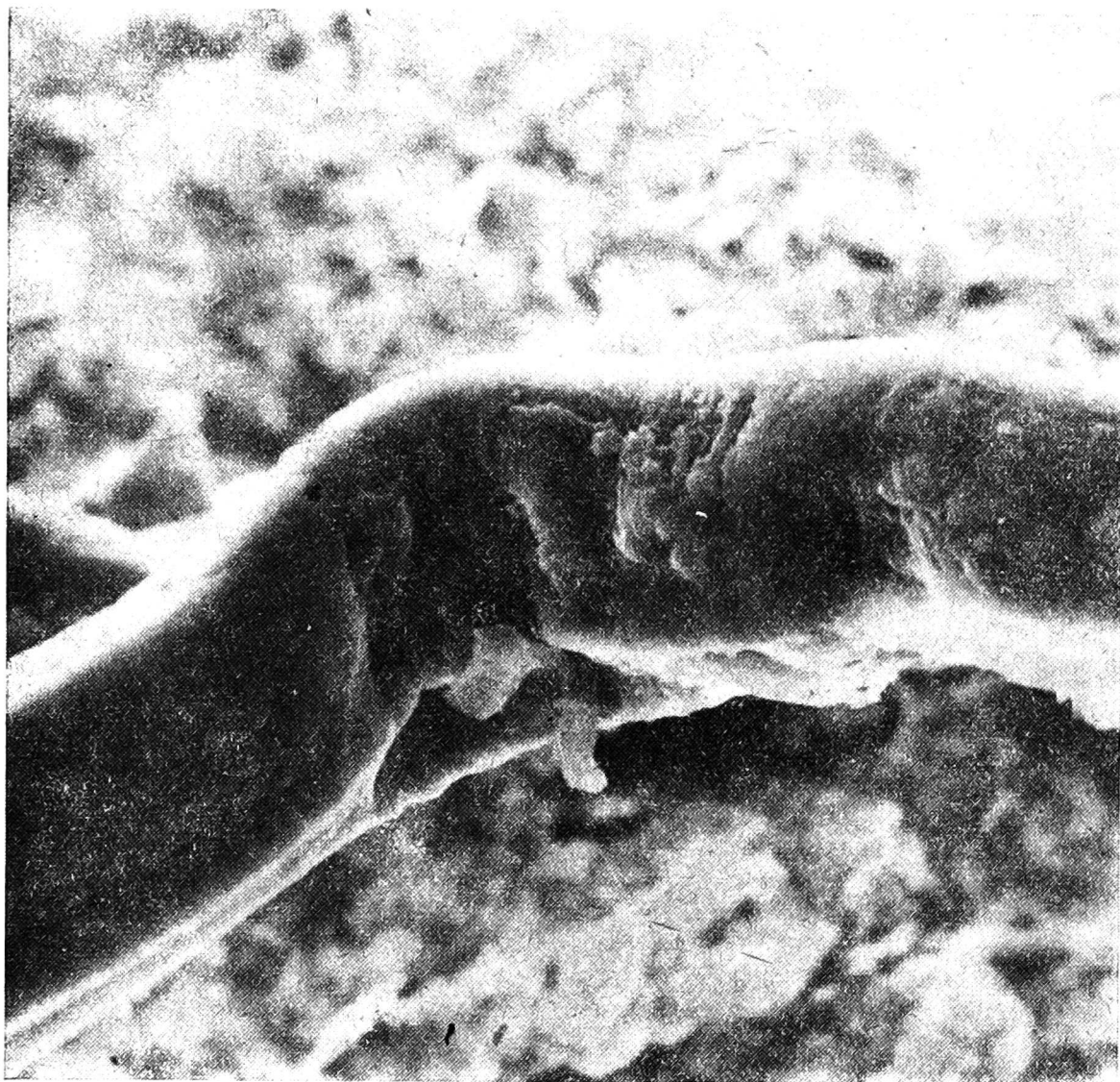
Rys. 14. Miejsce załamania włókna (mikroskop scanningowy, pow. 900 x)
