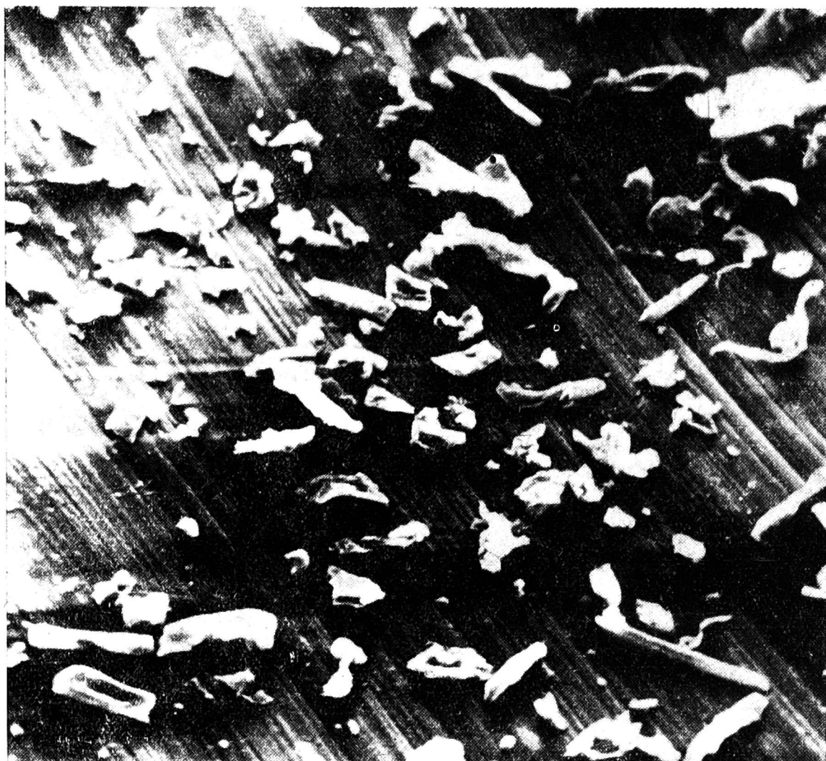
Rys. 21. Frakcja drobna sosnowej masy defibratorowej (mikroskop scanningowy, pow. 200 x)
