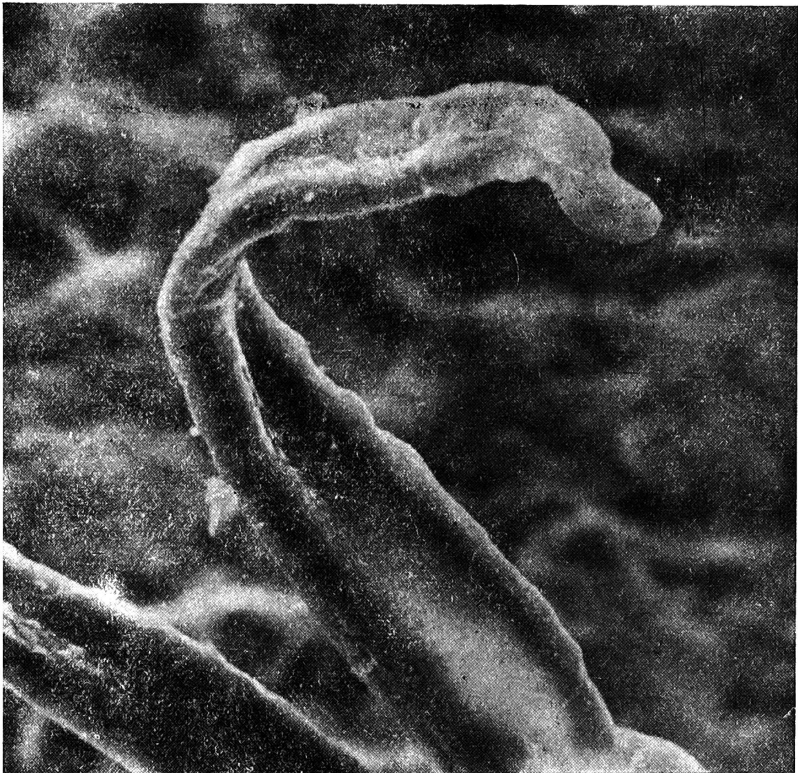
Rys. 15. Cienkościenne włókno odkształcone w procesie suszenia (mikroskop scannin- gowy, pow 940 x)
