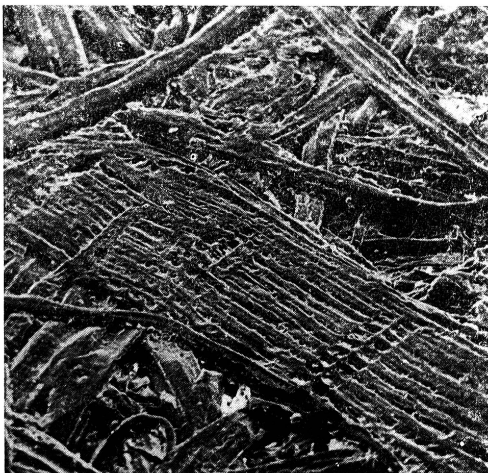
Rys. 24. Powierzchnia płyty pilśniowej nie pokryta wypełniaczem (mikroskop scanningowy, pow. 190 x)
