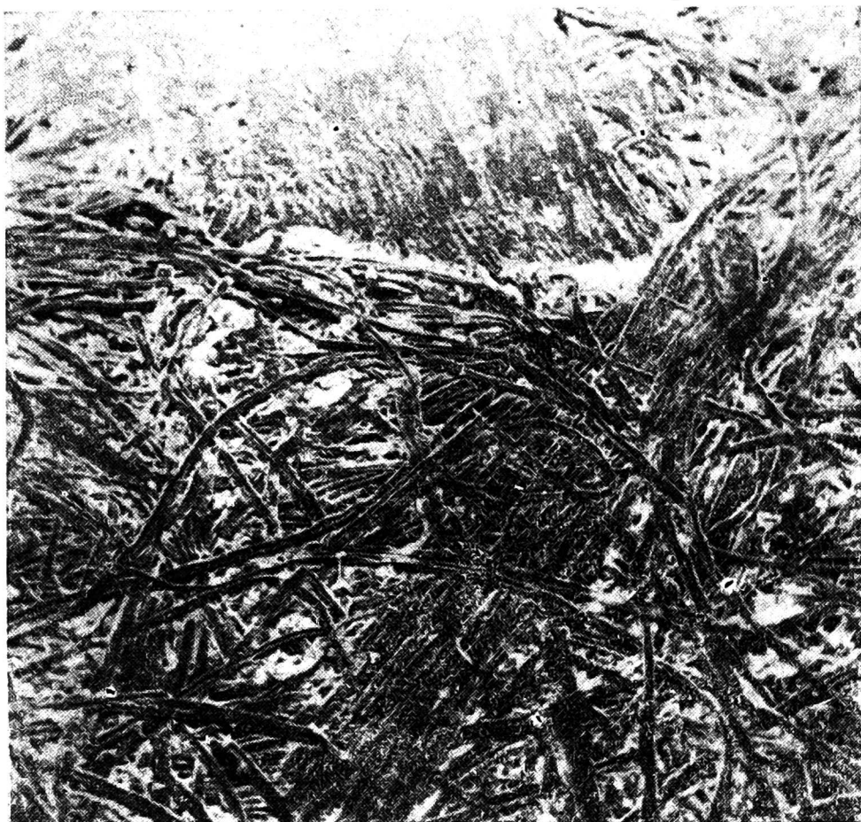
Rys. 27. Powierzchnia prawa płyty pilśniowej nie szlifowanej (mikroskop scanninowy, pow. 50 x)
