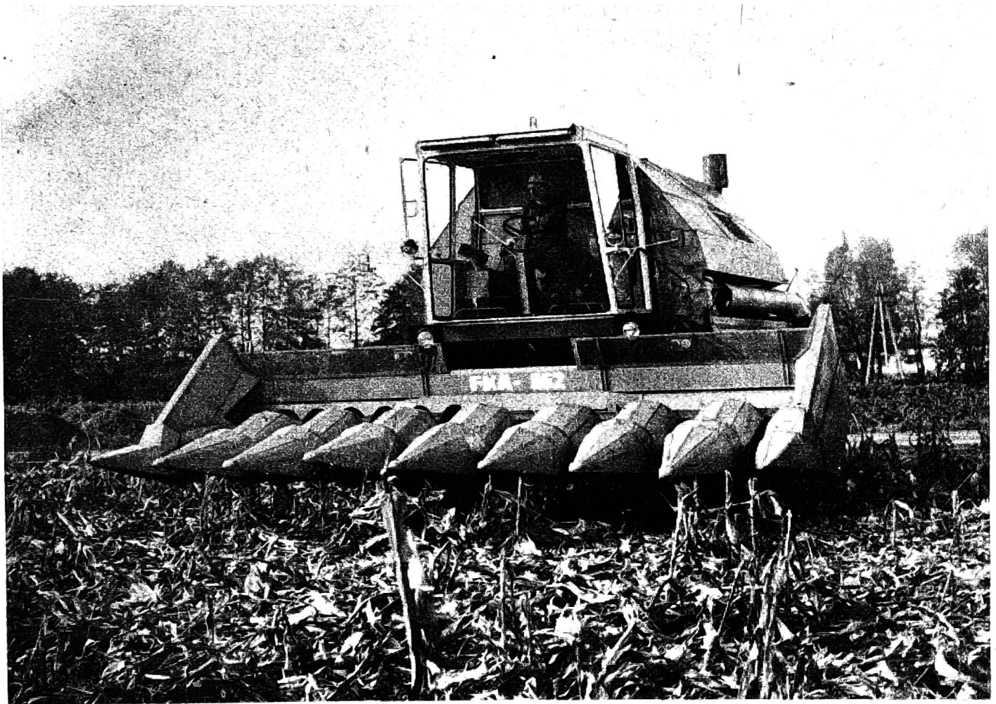
Rys. 1. Kombajn zbożowy Bizon Gigant z adapterem FKA-862 do zbioru kukurydzy
