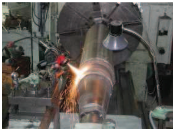
Рис. 3. – Схема плазменной наплавки Fig. 3. – Diagram of the plasma deposition
