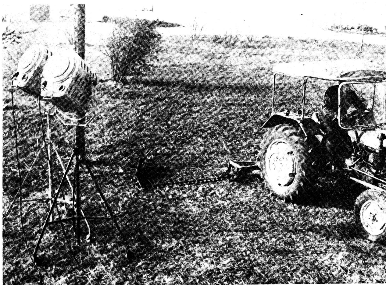
Rys. 4. Badanie drogi kamieni przy pracy kosiarką dwulistwową
