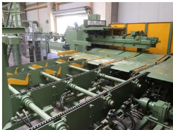
Bild 9: Zentrieranlage des Nachschnitts mit nachfolgendem Scanner zur geometrischen Vermessung und vorgelagerter Kaskade zur Speicherung der Produkte (Quelle: EWD)
