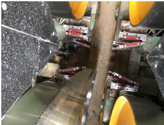
Bild 7: Aufgeklappte FBS_Magnet-Führungen beim Sägeblattwechsel (Quelle: EWD)
