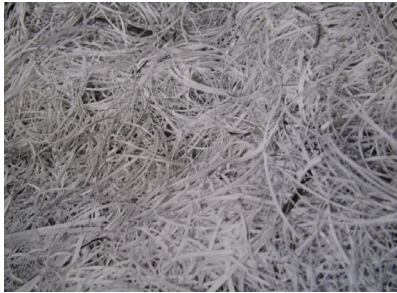
Bild 2. Holzwole a) „unbeschlämmt“ 1964 (Quelle: Heraklith), b) : manuelle Holzwoleherstellung („Hobler an der HWM- Holzwollemaschine“) 1964 (Quelle: Heraklith)
