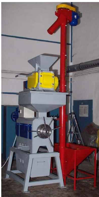
Rys. 1. Zestaw urządzeń przeznaczonych do wytłaczania oleju z nasion lnianki siewnej i innych oleistych roślin drobnonasiennych — The set of devices intended to oil pressing from seeds of Camelina sativa and other small-seed oil plants
