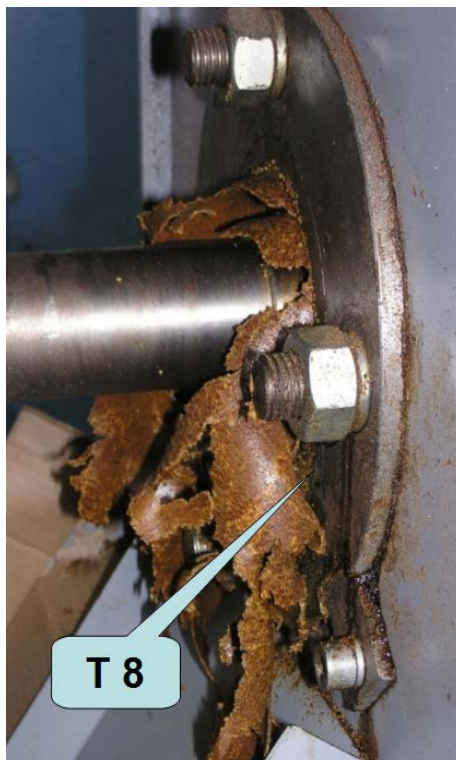
Rys. 4. Lokalizacja czujnika temperatury T8 na korpusie lawicy — T8 sensor location on the body of device
