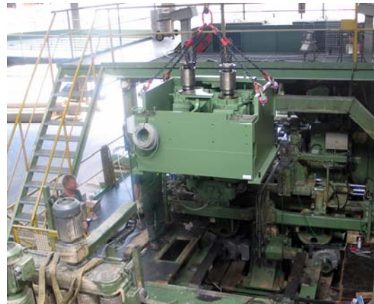
Bild 5 Austausch der Hauptmotoren der Bandsägen und der Horizontalkreissäge (Quelle: Dietz WCT)
