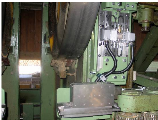
Bild 6. Testeinbau der Magnetsysteme und die Linie arbeitet wieder (Quelle: Dietz WCT)
