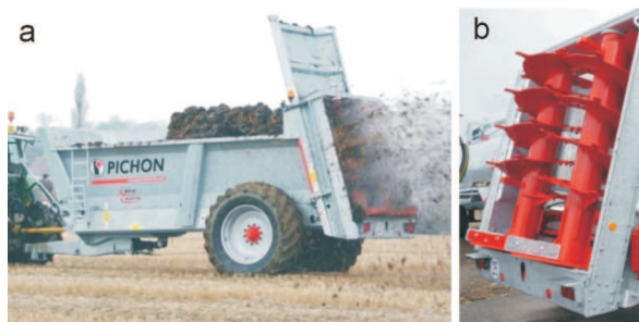
Rys. 8. Rozrzutnik obornika M1350 firmy Pichon - a), usytuowanie bębnow rozrzucających - b) [5] Fig. 8. M1350 muck spreader manufactured by Pichon - a), installing of spreading drums - b) [5]
