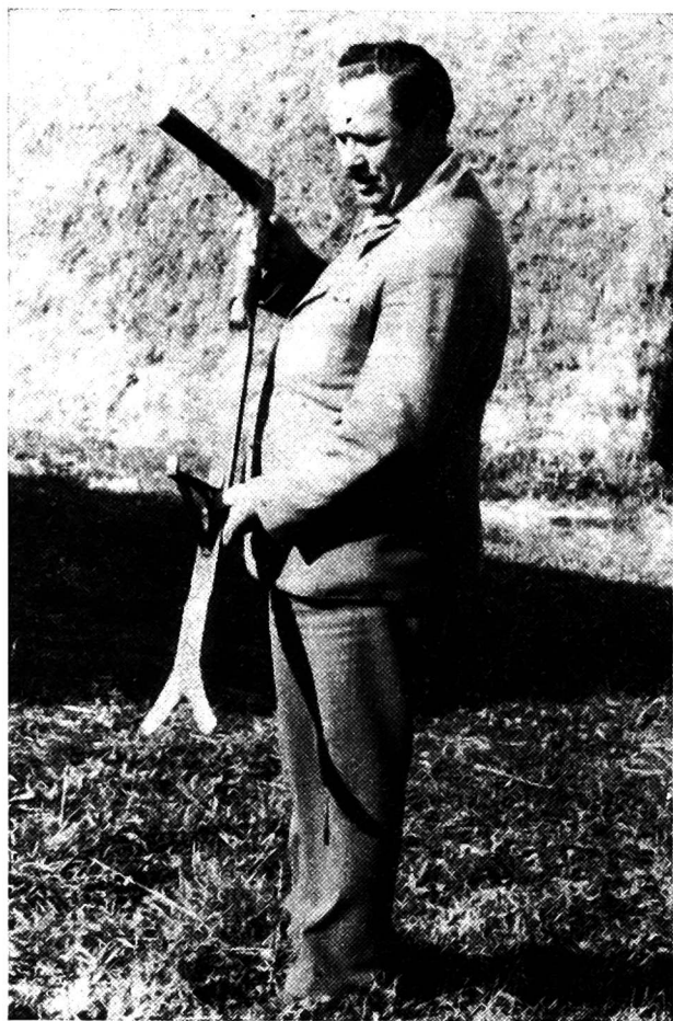
Rys. 11. Nóż stosowany do odcinania warstw suchego siana
