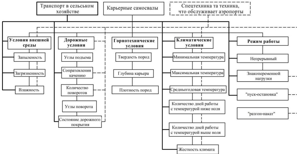
**Рис. 1.** Характеристика типов нестационарных условий эксплуатации
