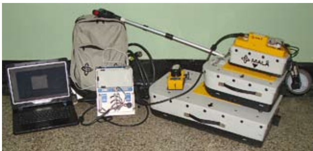
Ryc. 1. Aparatura georadarowa szwedzkiej firmy Mala Geoscience, model ProEx, która jest na stanie Katedry Geofizyki na Wydziale Geologii, Geofizyki i Ochrony Środowiska AGH w Krakowie. Na zdjęciu znajdują się (od lewej): laptop, jednostka centralna, anteny (od góry: 800 MHz z elektroniką, 500 MHz, 250 MHz i najmniejsza 1600 MHz) oraz wyzwalacz odległościowy.
