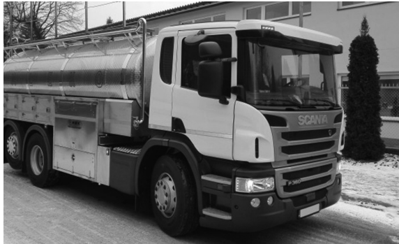
Figure 4. Tank with elliptical section on Scania chassis Rysunek 4. Zbiornik o przekroju eliptycznym na podwoziu Scania Source: [WSK „PZL – KROSNO” S.A.]
