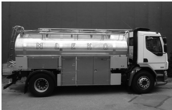
Figure 5. Tank with elliptical section on DAF chassis Rysunek 5. Zbiornik o przekroju eliptycznym na podwoziu DAF Source: [WSK „PZL – KROSNO” S.A.]
