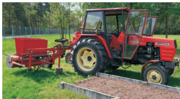
Rys. 2. Model funkcjonalny agregatu zawieszony asymetrycznie na wysięgniku ci'gnikowego siewnika do siewu punktowego przeznaczona do pracy w inspektach
