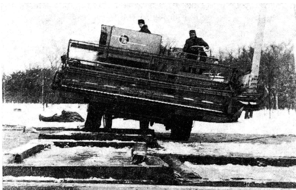
Rys. 7. Kombajn KZS-4 „Rekin” w czasie przejazdu przez odcinek toru ułożony z podkładów kolejowych
