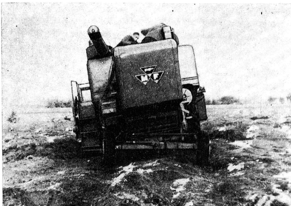
Rys. 8. Kombajn „Massey Ferguson 500” w czasie jazdy po terenowym odcinku pomiarowym
