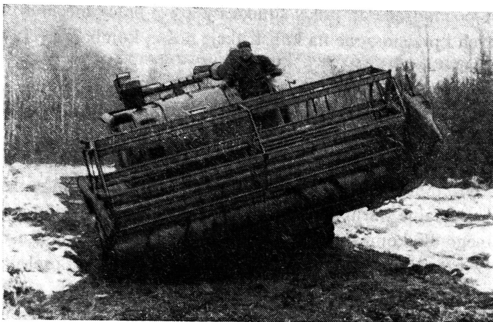
Rys. 5. Kombajn „Massey Ferguson 500” w czasie jazdy po odcinku toru próbnego
