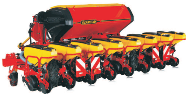
Rys. 1. Siewnik precyzyjny firmy Väderstad typu Tempo [6] Fig. 1. Precise seeder of Tempo type of Väderstad [6]
