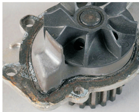
Rys. 5. Wyciek w miejscu montażu pompy Fig. 5. Leakage to assembly
