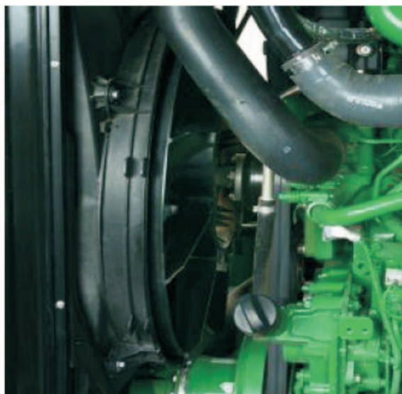
Rys. 3. Podzespoły układu chłodzenia; chłodnica oleju i pompa wodna ciągnika John Deere 6 M
