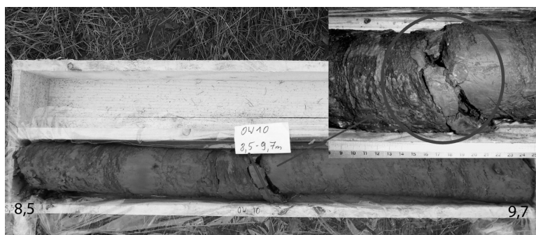
Rys. 3. Rdzeń wiertniczy z widoczną płaszczyzną poślizgu
