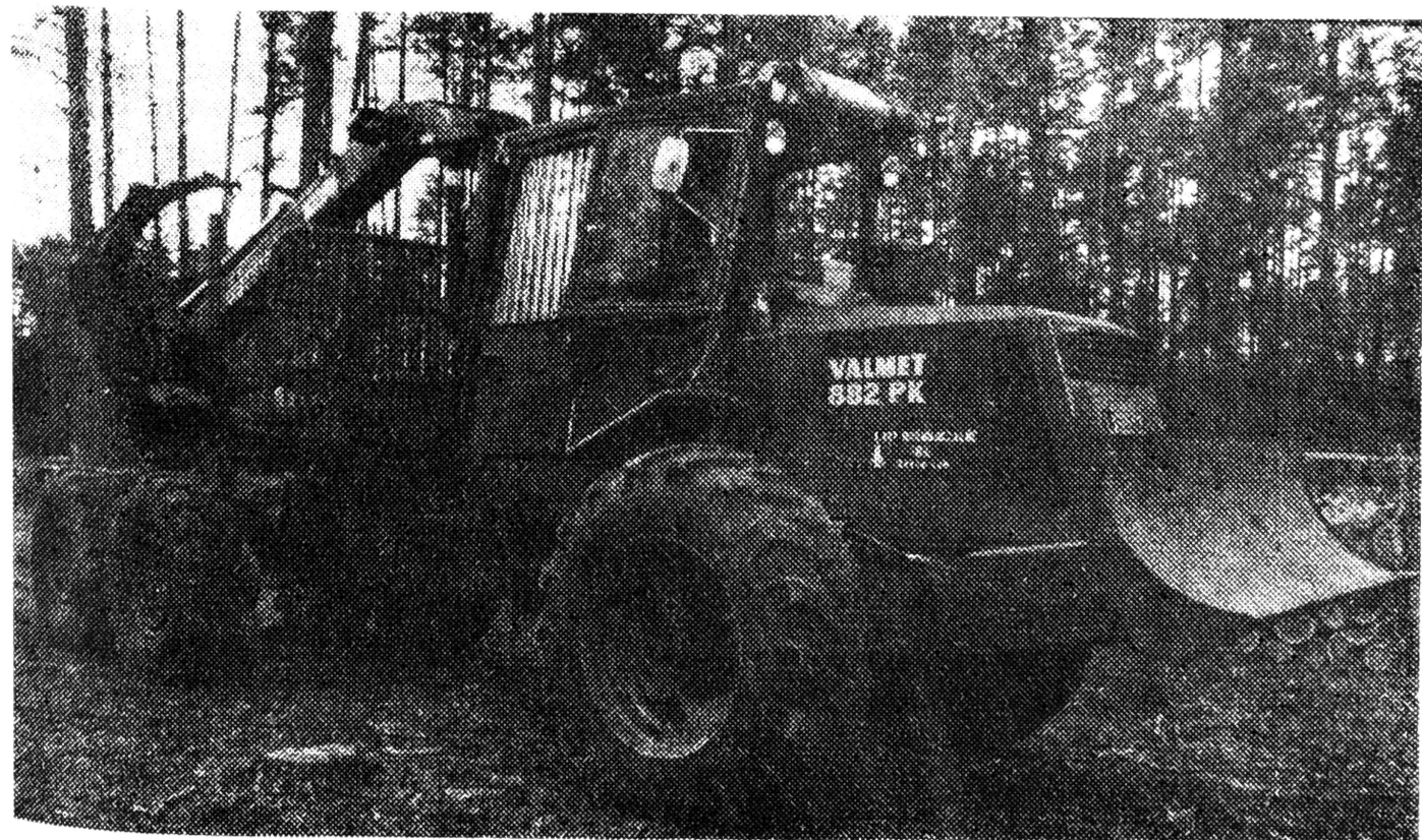
Ryc. 4. Zrywarka „nasiębierno-ciągąca z ławą kleszczową i żurawiem” Valmet 882-PK
