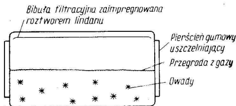
Ryc. 1. Zestaw płytek do badania lindanu.
