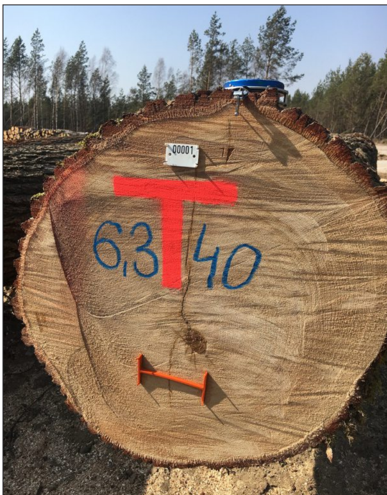
Fot. 1. Czoła kłód drewna zabezpieczone tzw. esami Źródło: Opracowanie własne.
