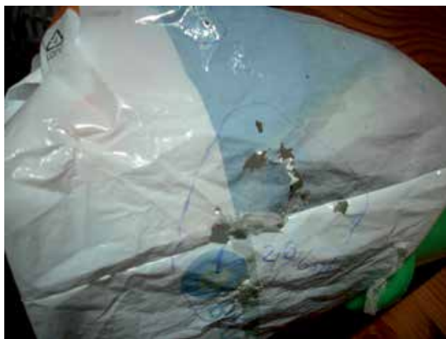
Ryc. 1. Otwory w folii polietylenowej i ich brak w folii polipropylenowej pod nią. Fot. M. Jeliński.
