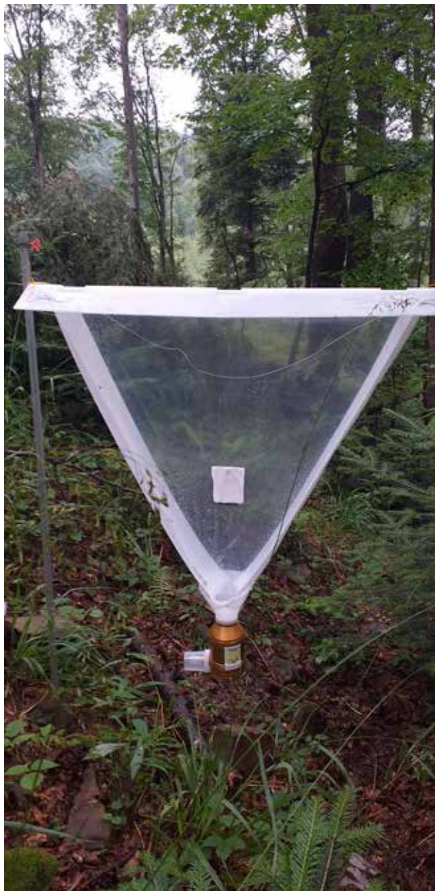
Ryc. 4. Pułapka barierowa IBL-2 wykorzystana do monitorowania owadów saproksylicznych. Fot. M. Kosibowicz.
