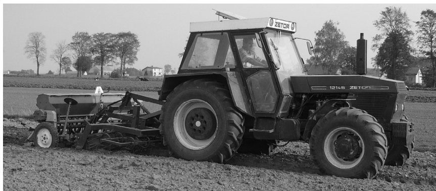
Rys. 1. Bierny agregat uprawowo-siewny składający się z siewnika uniwersalnego SO43/3C-1 „Poznaniak 6” i zespołu uprawowego AS30 firmy AGRO-MASZ
