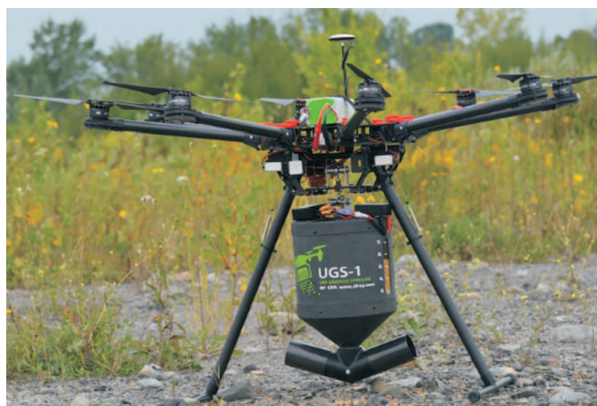
Rys. 3. Rozsiewacz granulatu USG-1 zamontowany na dronie DJI-S1000+
