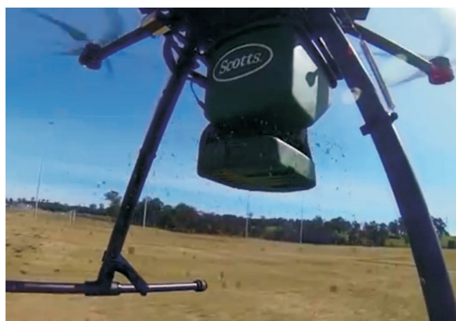
Rys. 4. Ręczny rozsiewacz zamontowany na dronie
