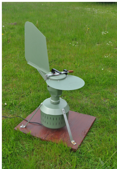
Fot. 2. Siedmiodniowa pułapka do wyłapywania zarodników (Burkard Manufacturing Co Ltd)
