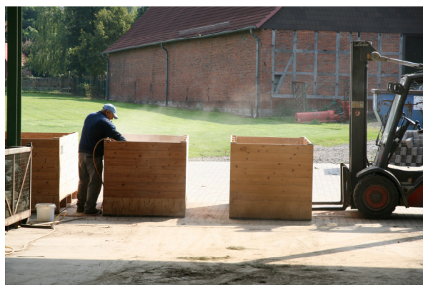
Fot. 2. Każdy kontener przed załadunkiem musi być gruntownie wyczyszczony. Na zdjęciu usuwanie zanieczyszczeń sprężonym powietrzem (fot. jw.)
