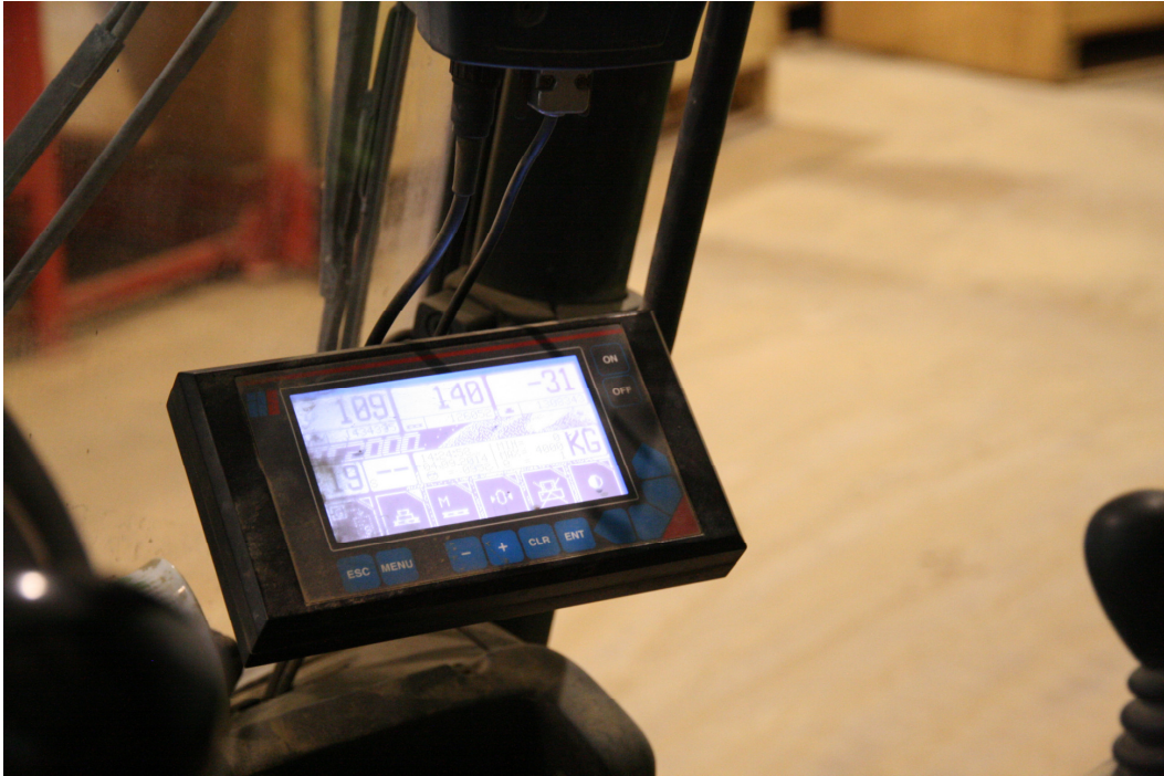
Fot. 4. Waga zamontowana bezpośrednio na wózku widłowym pozwala w szybki i prosty sposób na bieżąco ewidencjonować plony (fot. jw.)
