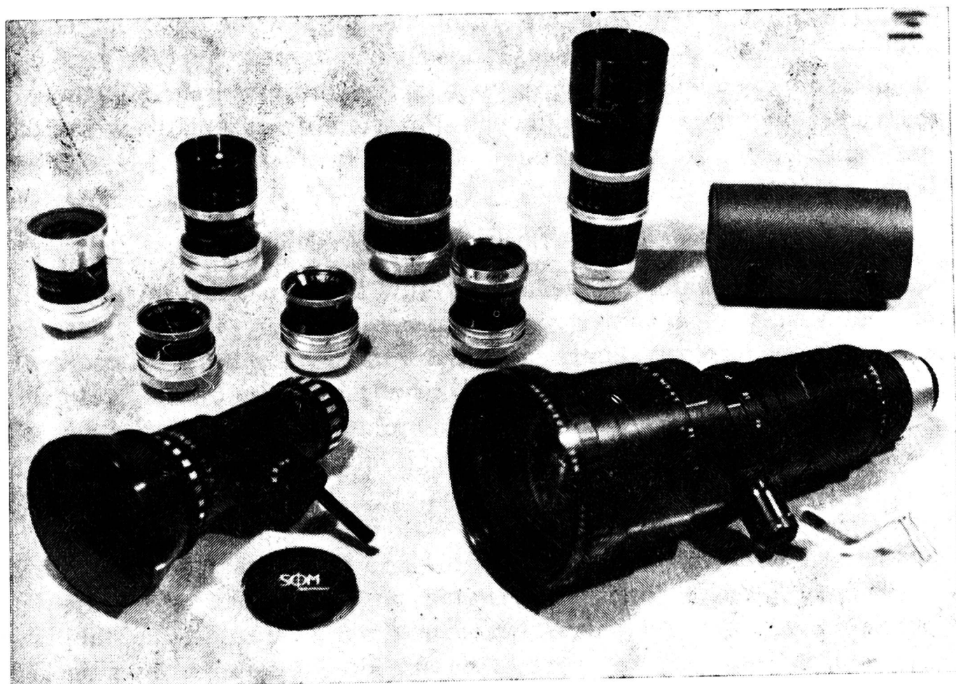
Rys. 2. Zestaw obiektywów do kamery Paillard Bolex. U dołu dwa obiektywy o zmiennej ogniskowej: Pan Cinar 85 oraz Angenieux 120
