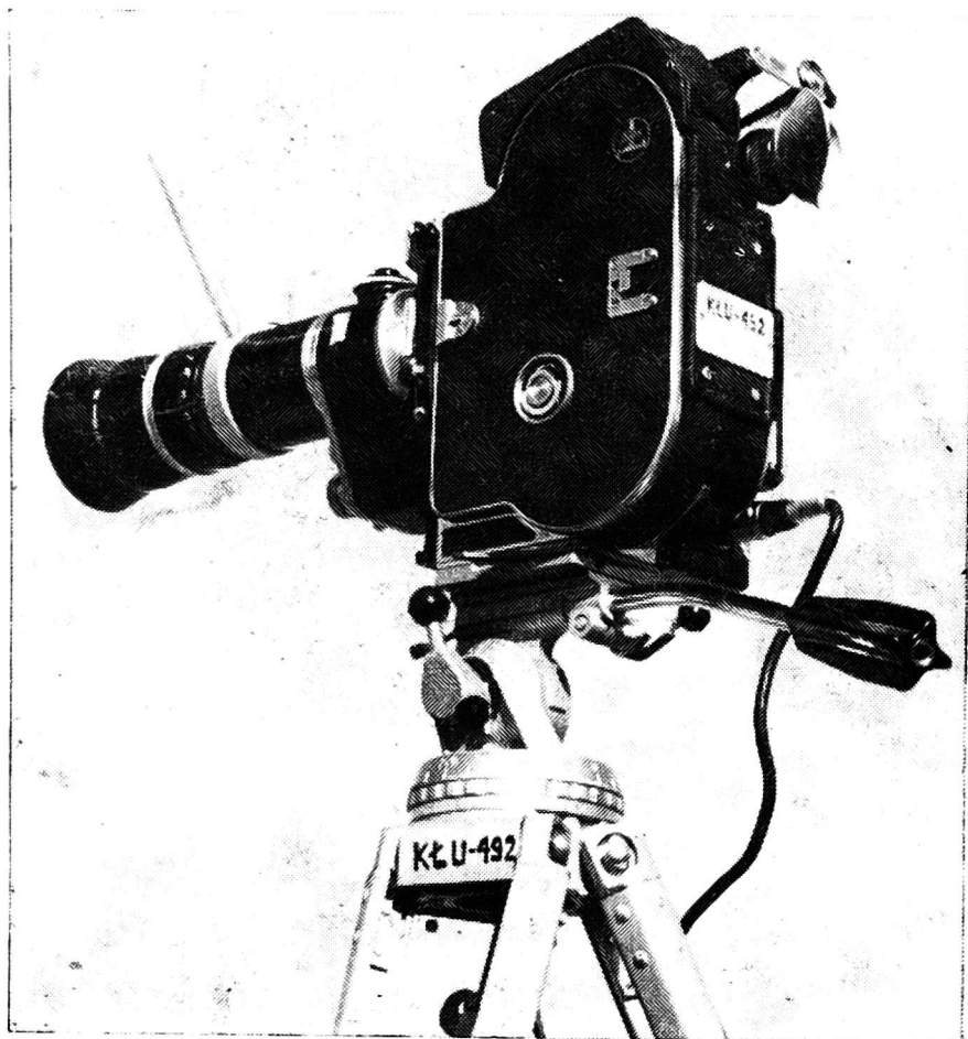
Rys. 3. Kamera Paillard Bolex H16 Reflex 5 z obiektywem o zmiennej ogniskowej Varia Switar 86 OE (fot. W. Woźniak )
