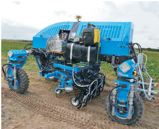
Rys. 2. Autonomiczny robot do prac polowych
