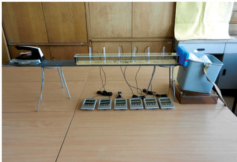
Fot. 1. Aparatura do badań termopreferendum owadów w warunkach laboratoryjnych (fot. J.R. Starzyk) Photo 1. Device for the tests on thermopreferendum in the laboratory conditions
