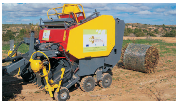
Rys. 1. Maszyna do zbierania i zwijania materiału drzewnego w sadach, w winnicach według wynalazku PIMR
