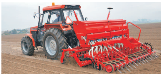
Rys. 4. Agregat uprawno-siewny z mechatronicznym układem sterowania
