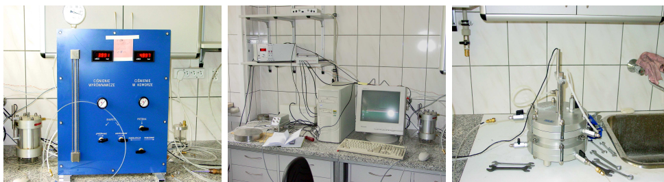
FOTOGRAFIA 2. Charakterystyczne elementy stanowiska do wykonywania badań w komorze Rowe'a PHOTO 2. View of major equipment for permeability test with use of Rowe's cell
