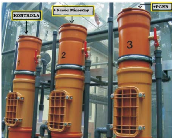
Fotografia 1. Prototypy Powolnych Filtrów Piaskowych zainstalowane w szklarni IBL
