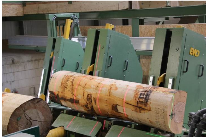
Bild 8. Stamm auf dem Spannwagen während des Vermessungsvorganges (fot. EWD)
