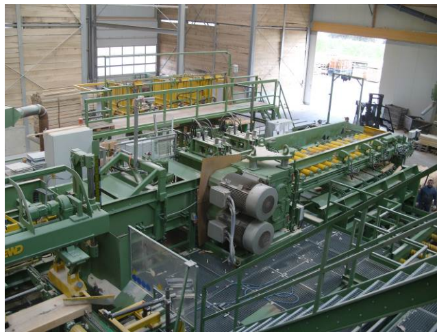
Bild 6. Doppelwellige Vielblattkreissäge (fot. Krzosek)
