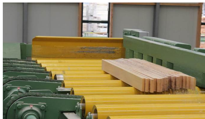
Bild 7. Palettenbretter nach der Vielblatt-Kreissäge (fot. EWD)
